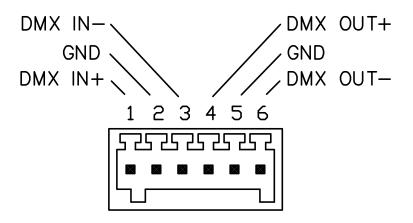
MALE 6 PIN HEADER CONNECTORS LOCATED ON THE BACK.
