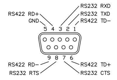
FEMALE DE9 CONNECTOR LOCATED ON THE BACK.
